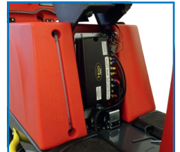
Integriertes Ladegerät und einfacher Zugang zur Elektronik
