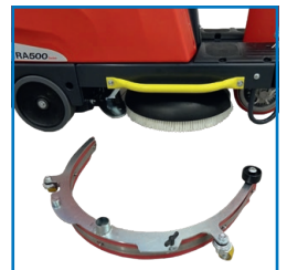
Saugdüse direkt hinter der Bürste macht die Maschine sehr wendig
